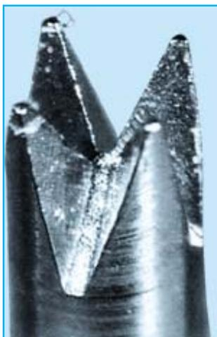
Рис. 4. Наконечник пробника без следов налипания остатков флюса
