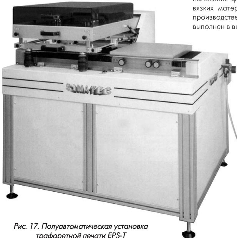
Рис. 17. Полуавтоматическая установка трафаретной печати EPS-T
