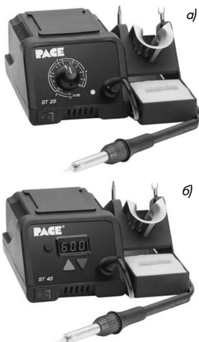
Рис. 8. Паяльные станции ST-25 (а) и ST-45 (б)
