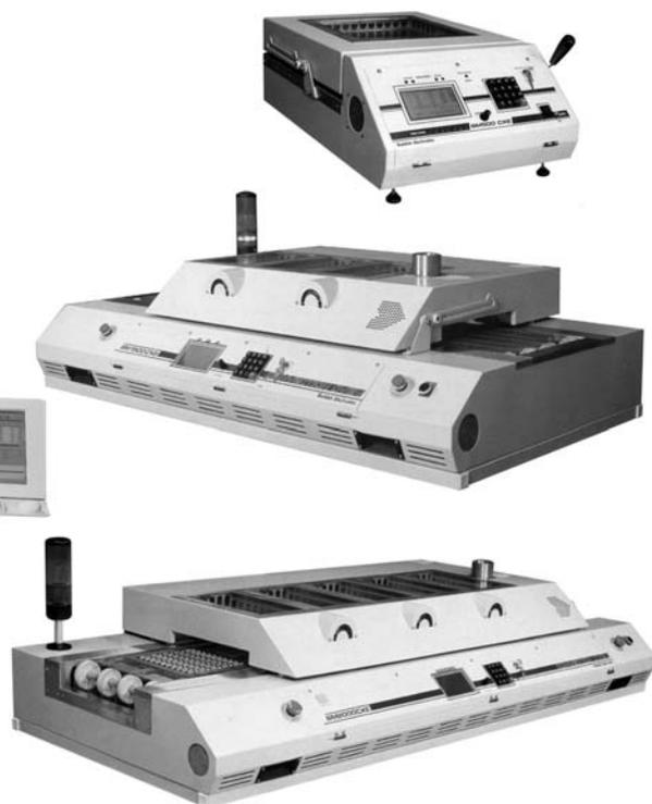
Рис. 23. Печи для конвекционной пайки
