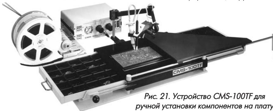
Рис. 21. Устройство CMS-100TF для ручной установки компонентов на плату
