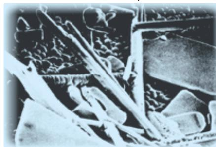
Рис. 7. Структура паяного соединения после длительной пайки с перегревом
