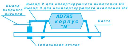
Рис. 14. Уменьшение токов утечки с помощью тефлоновой втулки
