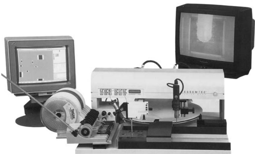
Рис. 9. Ручной манипулятор EXPERT-SA фирмы ESSEMTEC, оснащенный комплектом питателей
