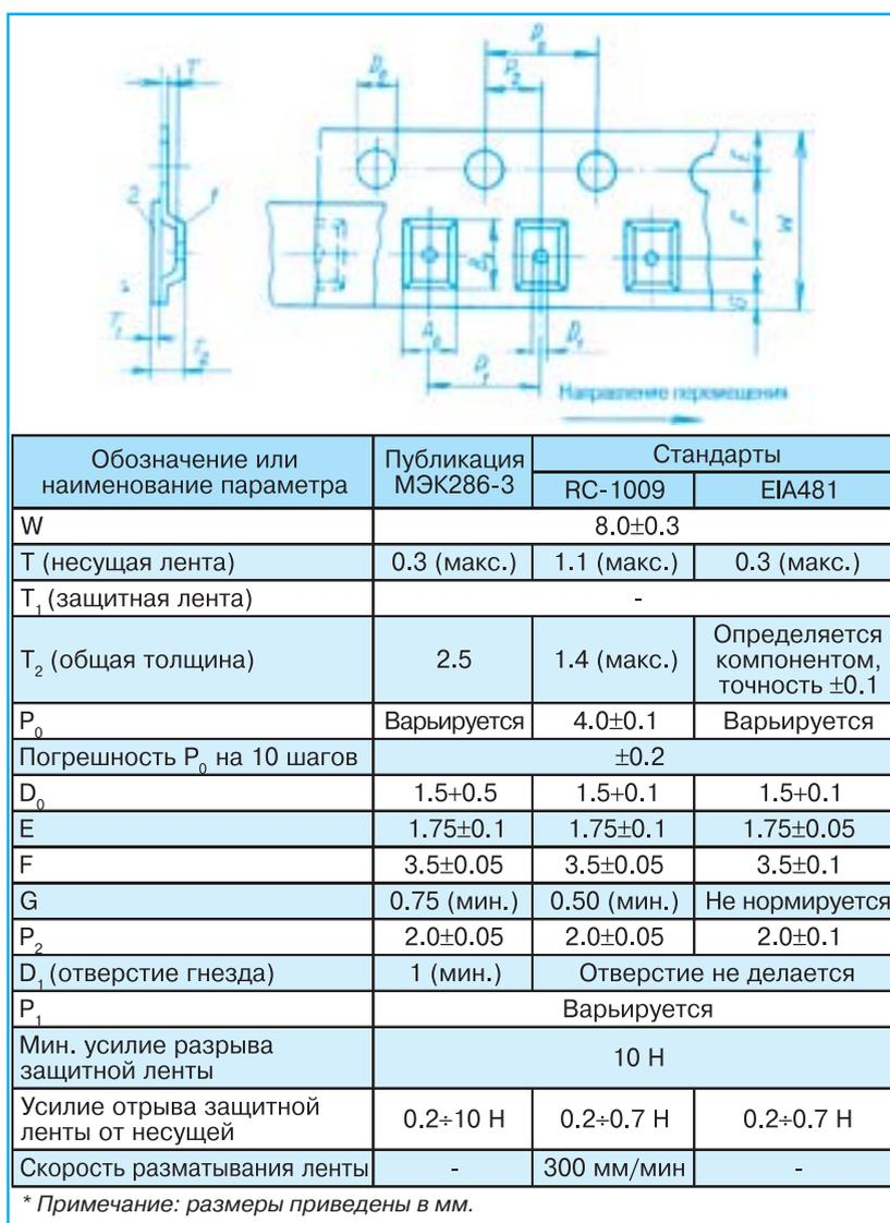
Рис. 2. Характеристики пластмассовой ленты шириной 8 мм (1 – несущая лента, 2 – защитная лента)
