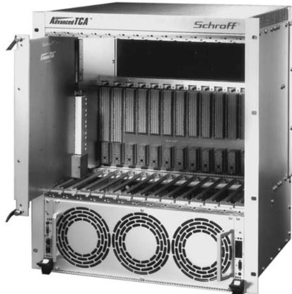
При конфигурации соединений по схеме Dual Star (двойная звезда, для которой необходимы два коммутатора) в одном 19-дюймовом корпусе можно установить 12 функциональных узлов. Однако, если эту схему преобразовать в схему Serial Mesh (последовательная сеть), то возможна установка всех четырнадцати функциональных узлов.
