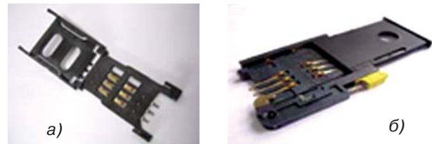
Рис. 3. Считыватели SIM-карт с верхней (а) и боковой загрузкой (б)
