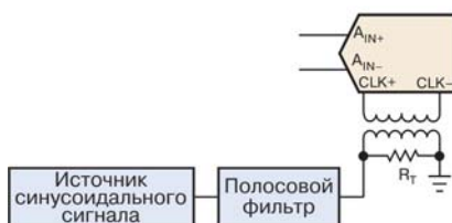
Рис. 2. Функциональная схема формирования дифференциальных тактовых сигналов
