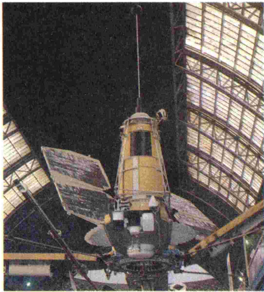
Океанографический спутник «Космос-1500» для наблюдения и контроля состояния Мирового океана
