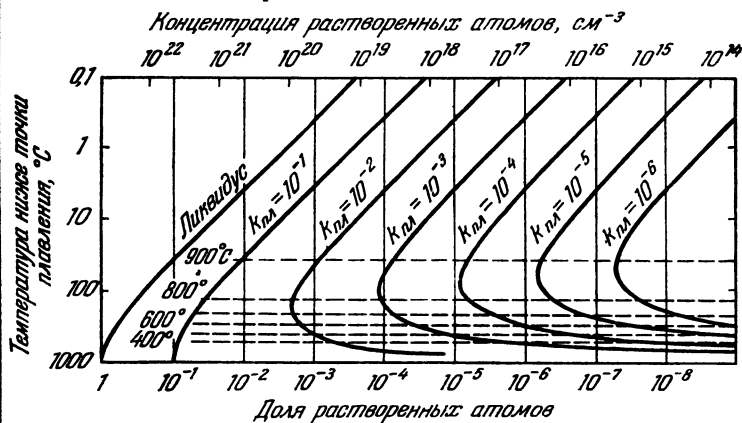
Рис. 189. Расчетные кривые для растворимости примесей в германии.
