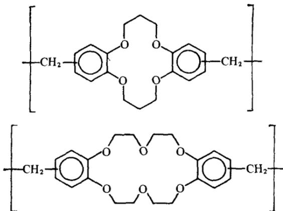
Смолы с краун-эфирной группой поглощают ионы щелочных, щелочноземельных и некоторых других металлов в виде заряженного ионного комплекса металла со связываемым анионом, компенсирующим заряд. В этом случае хроматографическое разделение можно
