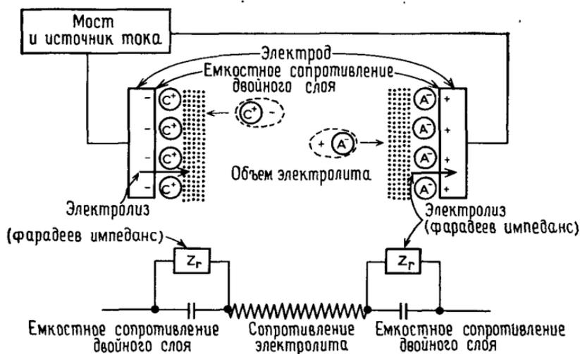
Рис. 3.1. Ячейка детектора электропроводности [2].
