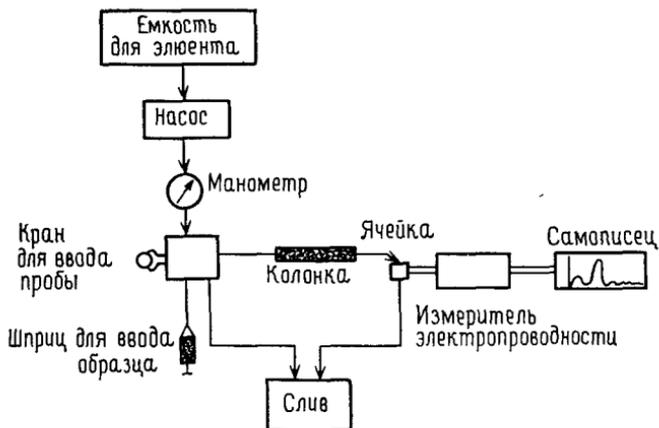
Рис. 5.1. Блок-схема одноколоночного ионного хроматографа [4].
