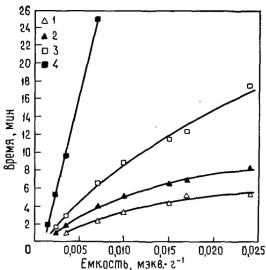
Рис. 5.14. Исправленные времена удерживания типичных анионов на смолах с различной емкостью.
