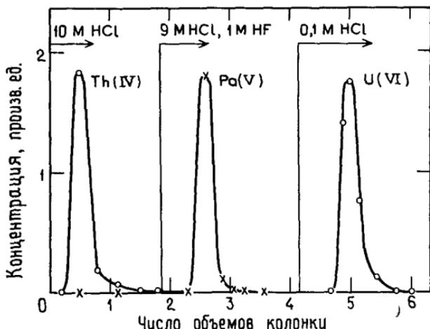
Рис. 2.1. Разделение ионов металлов на анионообменной смоле Dowex 1X10 (зерна размером 200 меш) [16].
