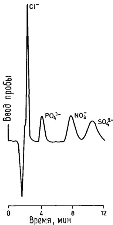
Рис. 4.13. Разделение хлорид-иона ( $5 \text{ млрд}^{-1}$ ), фосфата ( $20 \text{ млрд}^{-1}$ ), нитрата ( $20 \text{ млрд}^{-1}$ ) и сульфата ( $20 \text{ млрд}^{-1}$ ) в стандартных условиях, за исключением размеров компенсационной колонки ( $250 \times 3 \text{ мм}$ ), применения концентрирующей колонки и объема пробы  $10 \text{ мл}$  [62].
