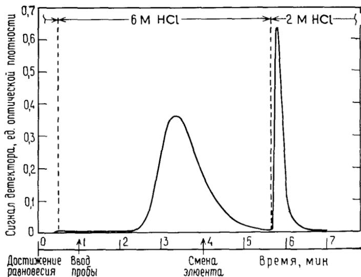
Рис. 8.2. Хроматографическое определение железа [4].
