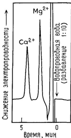
Рис 77. Разделение магния и кальция в разбавленной водопроводной воде [1].
