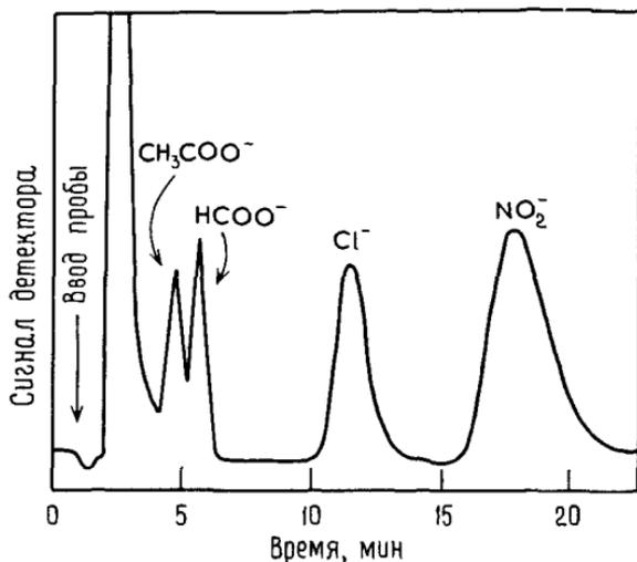
Рис. 5.4. Разделение ацетата ( $27,1 \text{ млн}^{-1}$ ), формиата ( $6,8 \text{ млн}^{-1}$ ), хлорида ( $5,1 \text{ млн}^{-1}$ ) и нитрита ( $15,8 \text{ млн}^{-1}$ ) с использованием  $5,0 \cdot 10^{-4} \text{ М}$  бензоата калия при pH 6,25 на анионообменной смоле Vydac SC [7].
