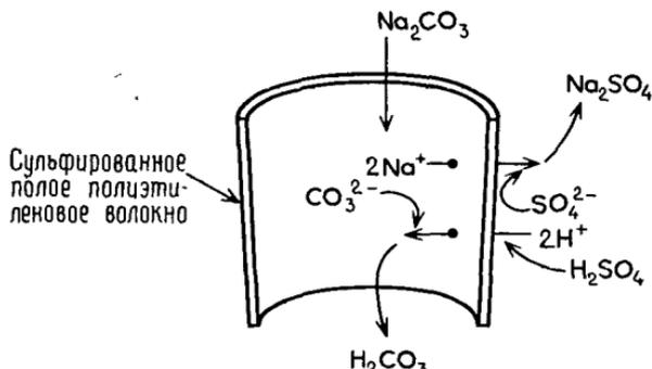
Рис. 4.4. Схема компенсации полыми волокнами [18].
