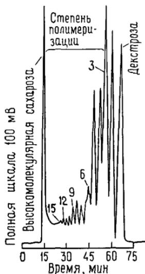
Рис. 9.3. Разделение патоки, подвергнутой ферментативному гидролизу на смоле Amipex 50 W-X4 (в  $Ag^+$ -форме) [7].
