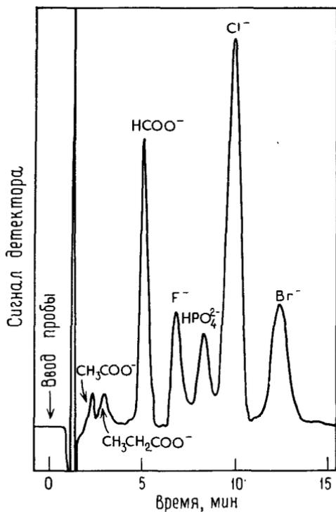
Рис. 5.5. Разделение ацетата ( $9,2 \text{ млн}^{-1}$ ), пропионата ( $30 \text{ млн}^{-1}$ ), формиата ( $9,4 \text{ млн}^{-1}$ ), фторида ( $7,2 \text{ млн}^{-1}$ ), фосфата ( $12,2 \text{ млн}^{-1}$ ), хлорида ( $8,4 \text{ млн}^{-1}$ ) и бромиды ( $9,8 \text{ млн}^{-1}$ ) [5].
