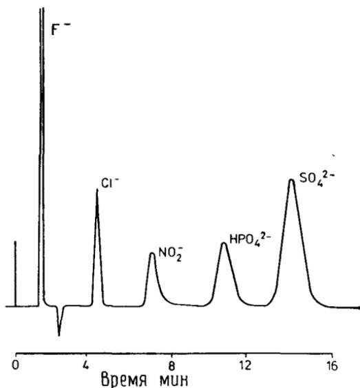
Рис. 4.15. Устранение мешающего влияния воды и карбонат-иона при разделении фтора, хлора и других анионов (рисунок предоставлен фирмой Diopex).
