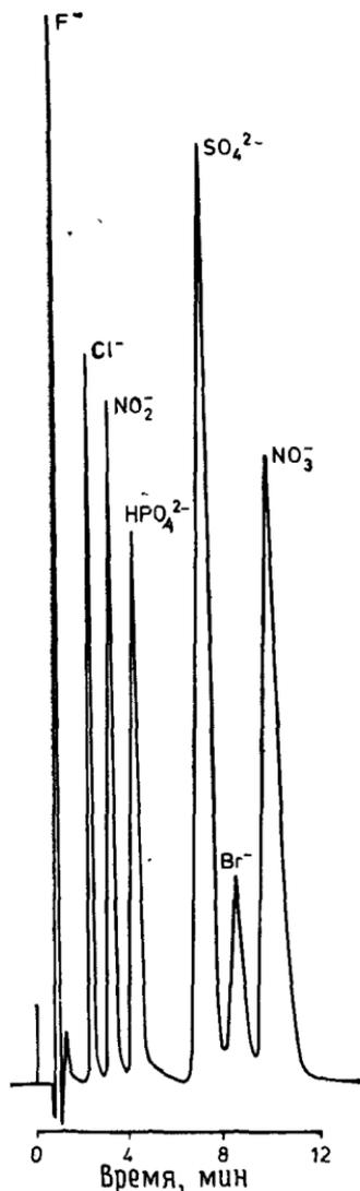
Рис. 4.16. Разделение анионов на «нитратной» колонке в среде 0,0045 М  $\text{Na}_2\text{CO}_3$ /0,002 М  $\text{NaOH}$ , 0,00075 М 4-цианфенола и 5% (по объему) ацетонитрила с предколонкой S2 (50×4 мм), разделяющей колонкой S2 (150×4 мм) и компенсационной колонкой (60×6 мм) (рисунок предоставлен фирмой Diopex).
