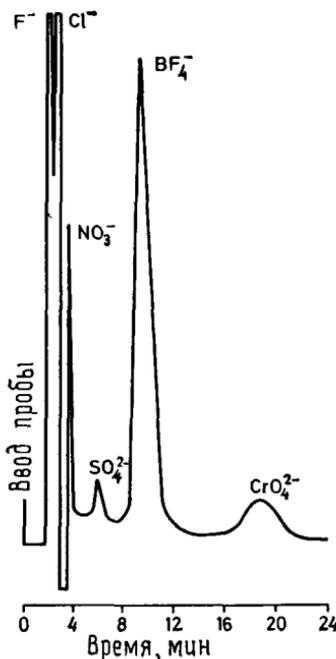
Рис. 4.14. Определение тетрафторбората в элюенте 0,003 М  $NaHCO_3$ /0,004 М  $Na_2CO_3$  на разделяющей колонке типа L-20 размером 500×3 мм [64].
