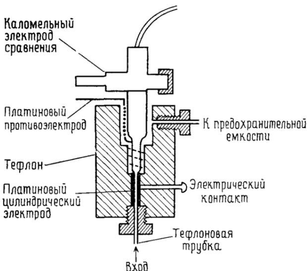
Рис. 3.5. Кулонометрический детектор с платиновым цилиндрическим электродом [27].
