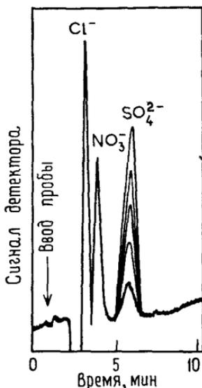
Рис. 5.3. Анализ стандартных растворов сульфата ( $2,75-13,75 \text{ млн}^{-1}$ ) в присутствии хлорида и нитрата [4]. Смола XAD-1 ( $0,04 \text{ экв.} \cdot \text{г}^{-1}$ ,  $44-57 \text{ мкм}$ ); элюент —  $5,0 \cdot 10^{-4} \text{ М}$  фталат калия, рН 6,2.
