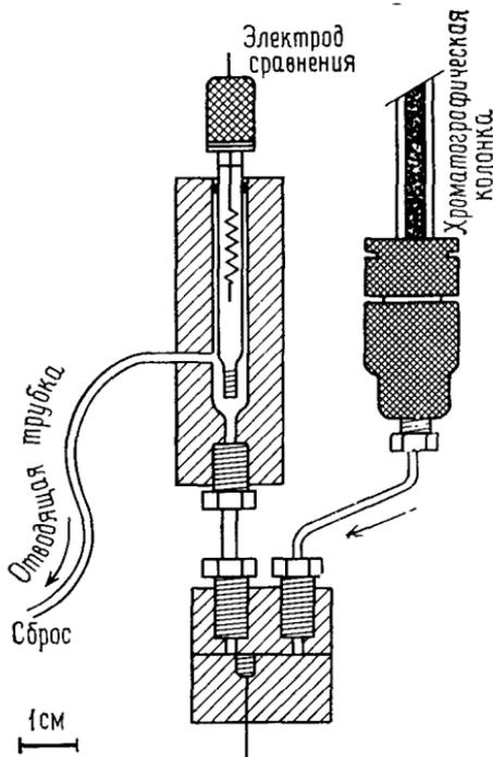
Рис. 3.4. Пленочный амперометрический детектор [26].
