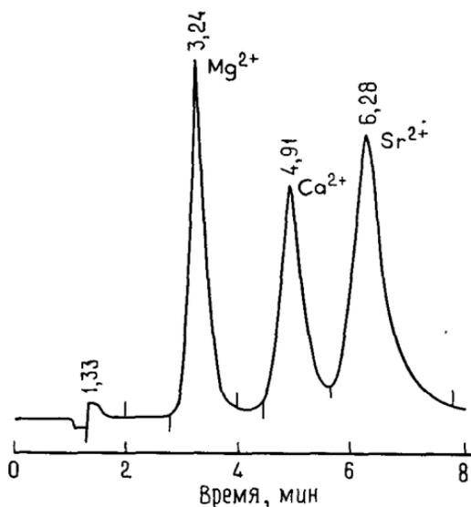
Рис. 6.2. Разделение магния ( $5 \text{ млн}^{-1}$ ), кальция ( $7 \text{ млн}^{-1}$ ) и стронция ( $25 \text{ млн}^{-1}$ ) в стандартных условиях (рисунок предоставлен лабораторией по исследованию алмазов де Бирса, ЮАР).
