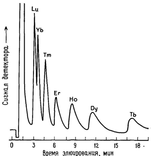
Рис. 7.12. Разделение ионов семи редкоземельных металлов. Элюент — раствор  $4 \cdot 10^{-3}$  М этилендиамина/ $3 \cdot 10^{-3}$  М  $\alpha$ -оксиномасляной кислоты (рН 4,5) (остальные условия эксперимента указаны в подписи к рис. 7.10).
