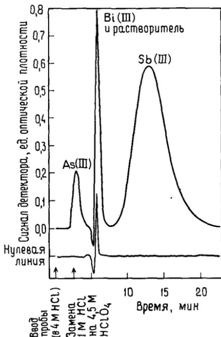
Рис. 8.4. Разделение мышьяка(III) (50 мкг), висмута(III) (2,5 мкг) и сурьмы(III) (250 мкг) [7].
