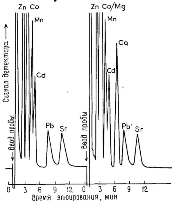
Рис. 7.10. Разделение ионов двухвалентных металлов.
