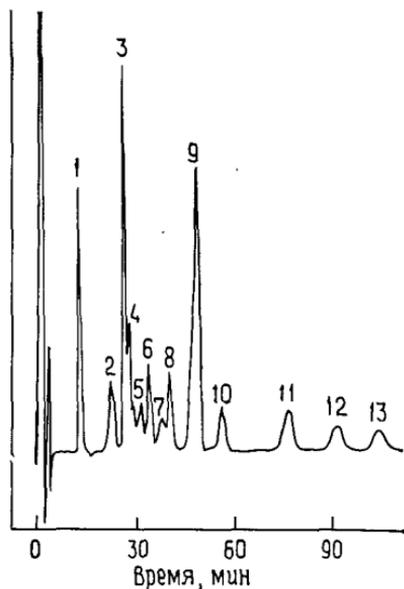
Рис. 9.5. Разделение аминокислот на колонке  $520 \times 9$  мм с катионообменником Aminex A-4 (17 мкм) [9].
