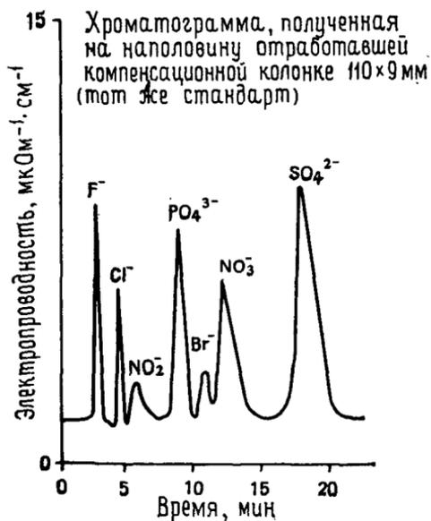
Рис. 4.3. Изменение реакции детектора при истощении компенсационной колонки [18].
