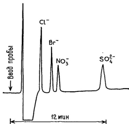
Рис. 5.7. Разделение хлорида ( $3 \text{ млн}^{-1}$ ), бромида ( $2 \text{ млн}^{-1}$ ), нитрата ( $3 \text{ млн}^{-1}$ ) и сульфата ( $3,5 \text{ млн}^{-1}$ ) на ионообменнике Vydac 302 IC в  $0,004 \text{ M}$  растворе фталевой кислоты (объем пробы  $100 \text{ мкл}$ ; детектор модели 213A фирмы Wescan) [10].
