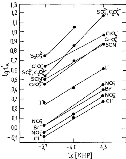
Рис. 5.12. Зависимость логарифма исправленного времени удерживания анионов от логарифма концентрации фталата калия для смолы XAD-1 ( $0,007 \text{ экв.} \cdot \text{г}^{-1}$ ) [5].
