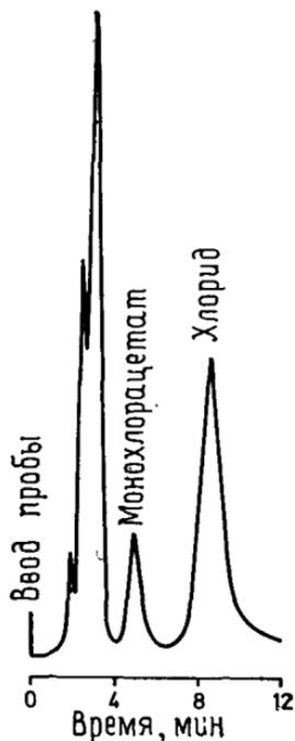
Рис. 4.10. Хроматограмма примесей, содержащихся в воздухе производственных помещений, в стандартных условиях, за исключением элюента ( $0,0015 \text{ M NaHCO}_3$ ) и более высокой скорости потока [38].
