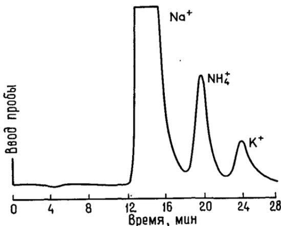
Рис. 6.4. Определение аммония в атмосферных аэрозолях [3].
