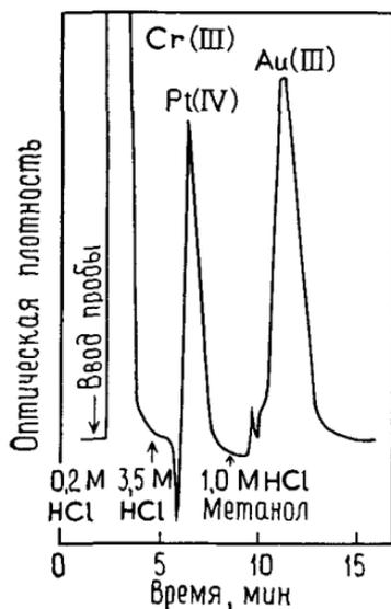
Рис. 8.3. Разделение хрома(III) (2,0 мг), платины(IV) (39 мкг) и золота(III) (7,8 мкг) на анионообменнике XAD-4 емкостью 0,21 мэв. · г<sup>-1</sup> [6].
