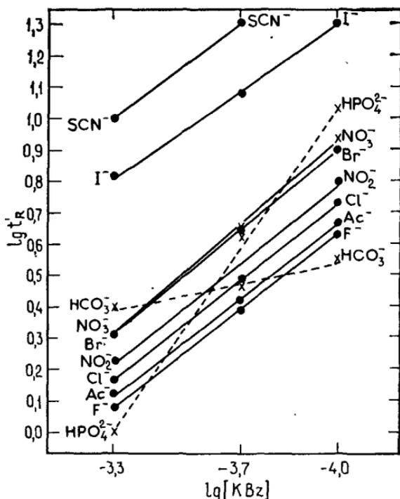
Рис. 5.10. Зависимость логарифма исправленного времени удерживания анионов от логарифма концентрации бензоата калия для смолы XAD-1 ( $0,007 \text{ мэкв} \cdot \text{г}^{-1}$ ) [5].
