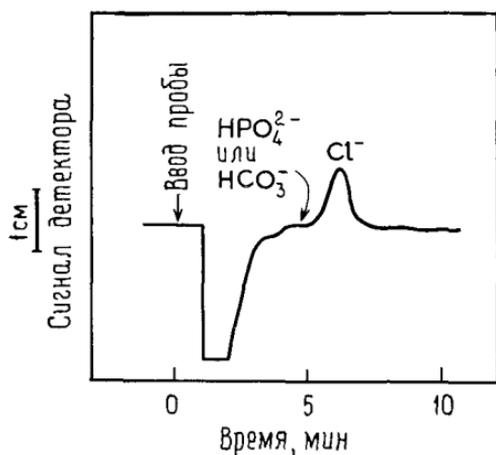
Рис. 5.16. Образец парового конденсата, содержащий  $9,3$  млрд<sup>-1</sup> хлор-иона, сконцентрированного из  $8,4$  мл [17]. Смола XAD-1 ( $0,0175$  экв.·г<sup>-1</sup>;  $44$ – $57$  мкм); элюент —  $2,0 \cdot 10^{-4}$  М бензоат калия, pH 6,2.
