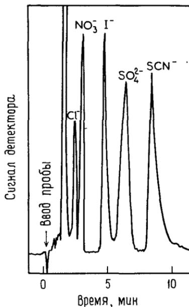
На рис. 5.9 представлен пример разделения пяти анионов в течение всего лишь 10 мин на колонке, заполненной частицами анионообменной смолы XAD-1 размером  $20\text{—}25 \text{ мкм}$ , которые были отсеяны влажным способом. Эта колонка обеспечила примерно вдвое большее число теоретических тарелок, чем прежние колонки с более крупными частицами смолы.
