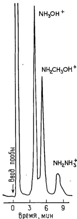
Рис. 7.9. Разделение гидроксил-амин ( $4,9 \text{ млн}^{-1}$ ), *N*-метилгидроксиламина ( $5,6 \text{ млн}^{-1}$ ) и гидразина ( $3,0 \text{ млн}^{-1}$ ).
