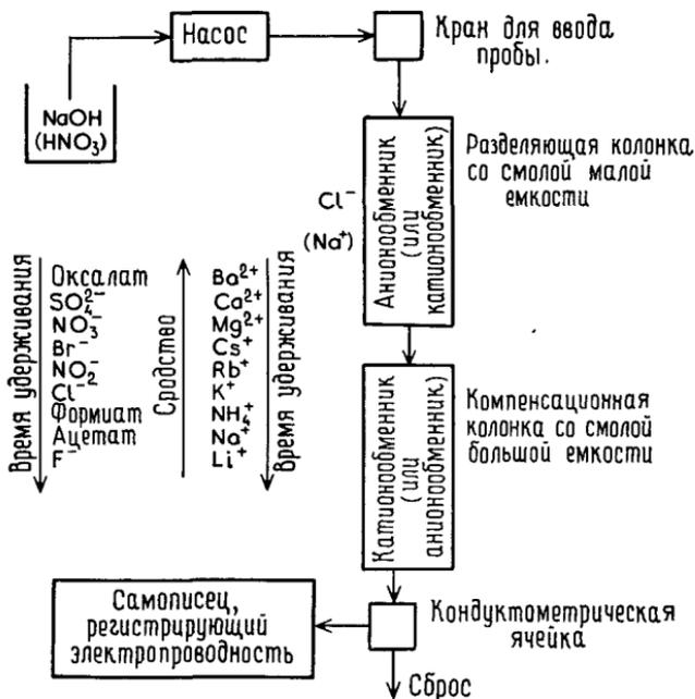
Рис. 4.1. Хроматографическая система фирмы Dionex.
