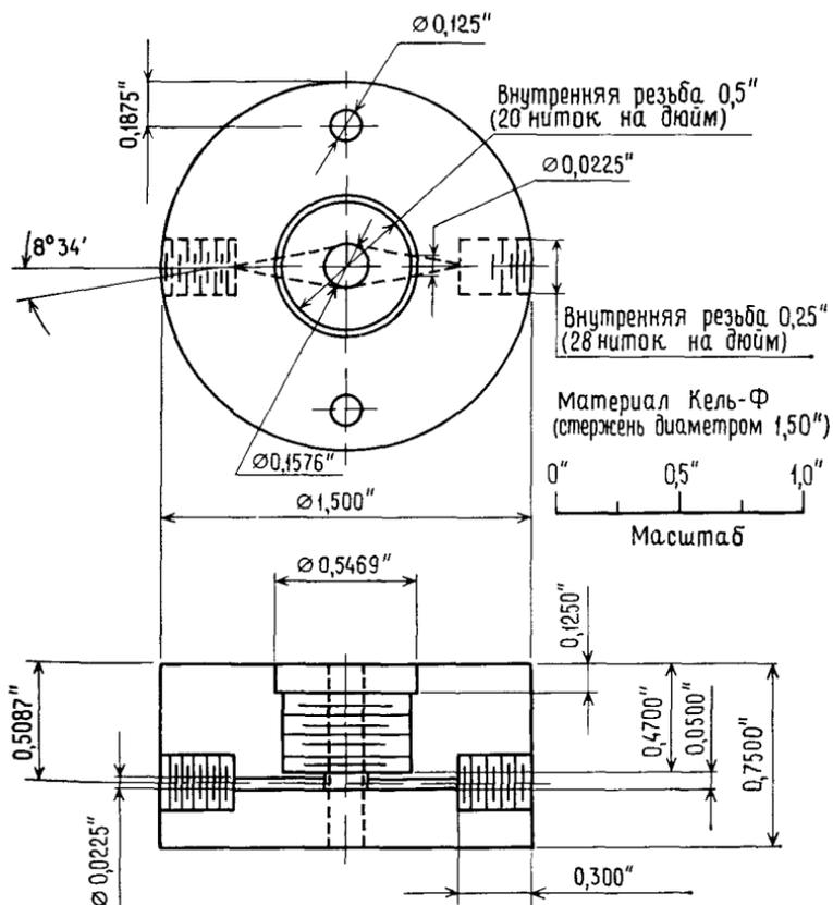
Рис. 3.2. Вихревая смесительная камера с разделенным тангенциальным входом [14]
