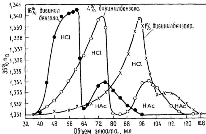
Рис 9.4. Влияние степени сшивания смолы на отторжение ионов (смола Dowex 50 с размером зерен 50—100 меш) [1].
