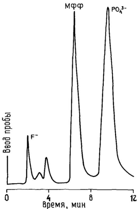
Рис. 4.12. Определение фтор-иона, монофторфосфата (МФФ) и фосфата в зубной пасте в стандартных условиях [60].
