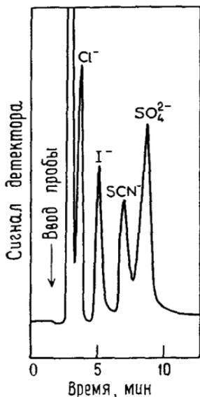
Рис. 5.2. Разделение ионов хлора ( $7,7 \text{ млн}^{-1}$ ), иода ( $29,5 \text{ млн}^{-1}$ ), тиоцианата ( $28,6 \text{ млн}^{-1}$ ) и сульфата ( $16,5 \text{ млн}^{-1}$ ) [4]. Смола XAD-1 ( $0,007 \text{ экв.} \cdot \text{г}^{-1}$ ,  $44-57 \text{ мкм}$ ); элюент —  $1,0 \cdot 10^{-4} \text{ М}$  фталат калия, рН 7,1.
