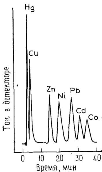
Рис. 8.11. Разделение ионов семи тяжелых металлов [18].
