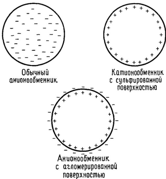
Рис. 4.2. Схема частиц различных ионообменных смол.
