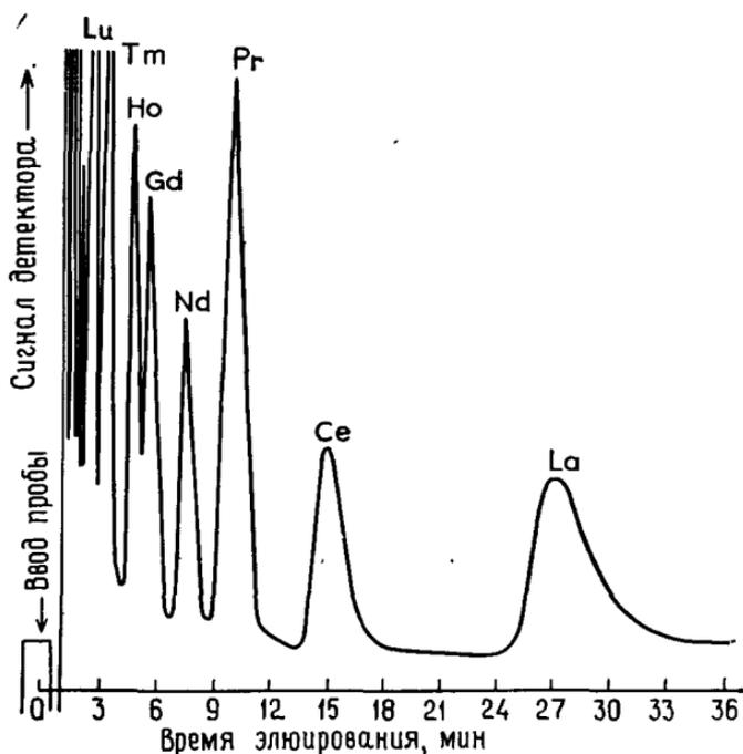
Рис. 7.11. Разделение ионов восьми редкоземельных металлов (условия эксперимента указаны в подписи к рис. 7.10).
