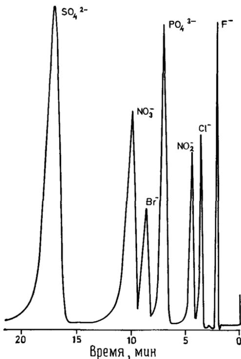
Рис. 4.8. Разделение фторида ( $3 \text{ млн}^{-1}$ ), хлорида ( $4 \text{ млн}^{-1}$ ), нитрита ( $10 \text{ млн}^{-1}$ ), фосфата ( $50 \text{ млн}^{-1}$ ), бромида ( $10 \text{ млн}^{-1}$ ), нитрата ( $50 \text{ млн}^{-1}$ ) и сульфата ( $50 \text{ млн}^{-1}$ ) в стандартных условиях (рисунок предоставлен лабораторией по исследованию алмазов де Бирса, ЮАР).
