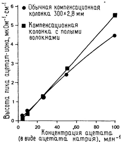
Рис. 4.6. Калибровочный график для ацетат-иона [18].
