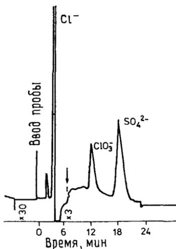
Рис. 4.11. Разделение хлорид-иона, хлората и сульфата (каждого по  $2 \text{ млн}^{-1}$ ) в 50%-ном растворе гидроксида натрия в стандартных условиях (разбавление 1 : 100).
