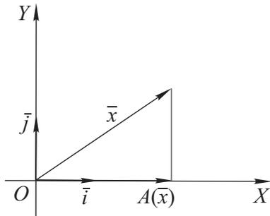
Рассмотрим линейное преобразование  $A : \overline{\mathbb{R}^2} \rightarrow \overline{\mathbb{R}^2}$ ,  $A$  — проецирование на ось  $OX$ . Найдём матрицу  $A$  в базисе  $\vec{i}, \vec{j}$ :
