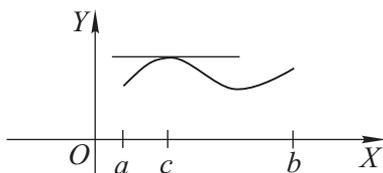
**Замечание.** На геометрическом языке теорема Ролля утверждает, что при указанных условиях касательная к графику функции в некоторых точках параллельна оси  $OX$ .
