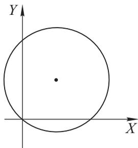
Удобнее вычислять этот интеграл в полярной системе координат. Уравнение окружности имеет вид:  $x^2 - 2x + y^2 - 2y = 0$ ,  $x^2 + y^2 = 2(x + y)$ ,  $\rho^2 = 2\rho(\cos \varphi + \sin \varphi)$ ,  $\rho = 2(\cos \varphi + \sin \varphi)$ .
