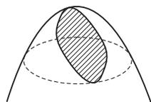
**Решение.** Найдём проекцию линии, по которой плоскость  $z = 2 - x - y$  пересекает параболоид  $2z = 4 - x^2 - y^2$ . Для этого исключим переменную  $z$ :  $4 - x^2 - y^2 = 2(2 - x - y)$ . После простых преобразований получим уравнение  $(x - 1)^2 + (y - 1)^2 = 2$ , которое задаёт окружность радиуса  $\sqrt{2}$  с центром  $(1, 1)$ . Ясно, что проекция тела  $T$  на плоскость  $XOY$  ограничена этой окружностью. Проведём интегрирование по  $z$ .
