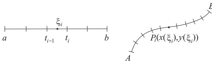
Так как  $\Delta L_i = \int_{t_{i-1}}^{t_i} \sqrt{(x'(t))^2 + (y'(t))^2} dt$ , то
