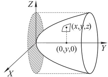
Будем вычислять поверхностный интеграл, проецируя поверхность на плоскость  $XOZ$ . Проекция есть круг  $x^2 + z^2 \leq 4$ . Так как  $y = \frac{1}{2}(x^2 + z^2)$ , то
