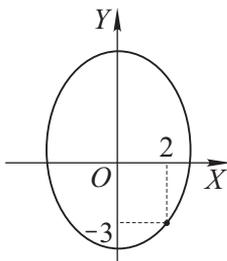
Так как  $F'_y(2, -3) = -\frac{1}{3} \neq 0$ , то неявная функция определена, и её производная  $y'(x) = -\frac{F'_x}{F'_y} = -\frac{\frac{x}{4}}{\frac{y}{9}} = -\frac{9x}{4y}$ .
