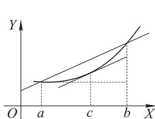
Лагранжа. Величина  $\frac{f(b) - f(a)}{b - a}$  равна тангенсу угла наклона секущей, проведённой через точки  $(a, f(a))$ ,  $(b, f(b))$ . Так как  $f'(c)$  — тангенс угла наклона касательной, то теорема Лагранжа фактически утверждает: при указанных условиях всегда найдётся точка  $c \in (a, b)$ , в которой касательная параллельна секущей.
