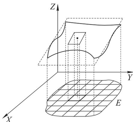
Плоская область  $E$  является *однозначной* проекцией  $\Sigma$  на плоскость  $XOY$ : в каждую точку  $E$  проецируется только одна точка  $\Sigma$ . Рассмотрим разбиение  $E$  кусочно-гладкими кривыми:
