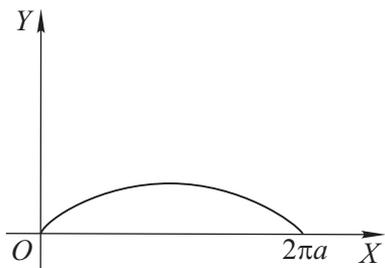
**Решение.** Циклоида задана параметрически. Сделаем схематический чертёж. Значению  $t = 0$  соответствует начало координат:  $x = 0$ ,  $y = 0$ . При возрастании  $t$  абсцисса  $x$  возрастает (так как её производная  $x'_t = a(1 - \cos t)$  всегда положительна), а ордината  $y$  при  $t = 2\pi$  снова становится равной нулю:
