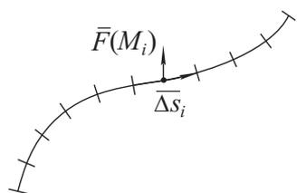
Выберем произвольно точки  $M_i \in \Gamma_i$ . Допуская некоторую погрешность, будем считать, что сила на  $\Gamma_i$  постоянна и равна  $\bar{F}(M_i)$  — силе в выбранной точке. Также допуская погрешность, заменим перемещение по  $\Gamma_i$  прямолинейным перемещением  $\overline{\Delta s_i}$  (вектор, направленный из начала  $\Gamma_i$  в конец  $\Gamma_i$ ). Работа постоянной силы на прямолинейном пути, как известно из школьного курса физики, вычисляется так:
