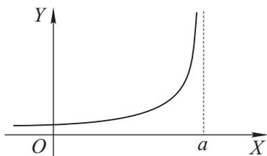
В случае вертикальной асимптоты  $x = a$  неограниченное удаление точки графика от начала координат (требуемое в определении асимптоты) равносильно тому, что  $|f(x)| \rightarrow \infty$  при  $x \rightarrow a$ , а стремление к 0 расстояния между графиком и асимптотой равносильно тому, что  $x \rightarrow a$ . Отсюда следует, что прямая  $x = a$  является вертикальной асимптотой графика
