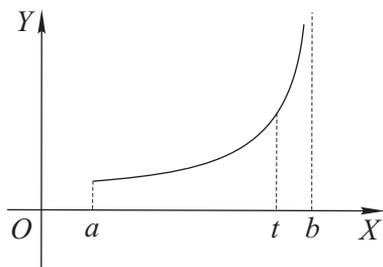
Пусть функция  $f(x)$  непрерывна на  $[a, b)$  и не ограничена в окрестности точки  $b$ . Например,  $\lim_{x \rightarrow b} f(x) = +\infty$ , как на рисунке. Возьмём  $t \in [a, b)$ . Тогда на отрезке  $[a, t]$  функция непрерывна, а значит существует интеграл  $\int_a^t f(x) dx$ . **Несобственным**
