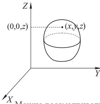
Элемент тела с координатами  $(x, y, z)$  имеет массу  $\rho(x, y, z) dx dy dz$ . Его расстояние от оси  $OZ$  равно  $\sqrt{x^2 + y^2}$ . Значит, момент инерции равен  $J = \iiint_T (x^2 + y^2) \rho(x, y, z) dx dy dz$ .
