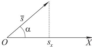
вектор  $\bar{s}$  образует с осями координат углы  $\alpha, \beta, \gamma$ . Косинусы этих углов, напомним, называются направляющими косинусами вектора  $\bar{s}$ . Если  $\bar{s} = (s_x, s_y, s_z)$ , то, рассматривая соответствующий прямоугольный треугольник, видим, что  $\cos \alpha = \frac{s_x}{|\bar{s}|}$ . Так же и  $\cos \beta = \frac{s_y}{|\bar{s}|}$ ,  $\cos \gamma = \frac{s_z}{|\bar{s}|}$ .
