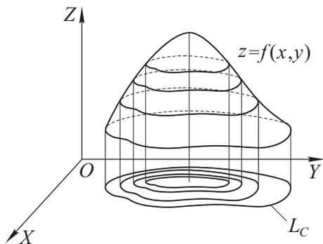
Для плоского поля уравнения  $f(x, y) = C$  определяют *линии уровня*  $L_C$ . Иногда удобно задавать плоское скалярное поле с помощью линий уровня. Например, изотермы на карте погоды дают представление о распределении температур. Линии одинаковой высоты на карте местности позволяют судить о наличии возвышенностей, крутизне склонов.
