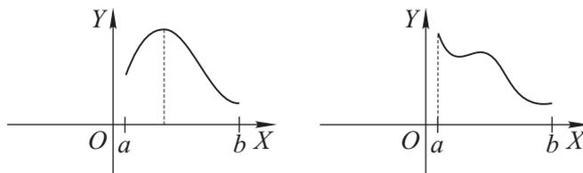
Таким образом, из всех максимумов нужно выбрать наибольший, а затем сравнить его со значениями функции на концах отрезка. На практике поступают ещё проще: находят критические точки 1-го рода («подозрительные на экстремум») и, не проводя их дальнейшего исследования, вычисляют в них значения функции. Вычисляют также значения функции на концах  $[a, b]$ . Из всех полученных чисел выбирают наибольшее (или наименьшее).
