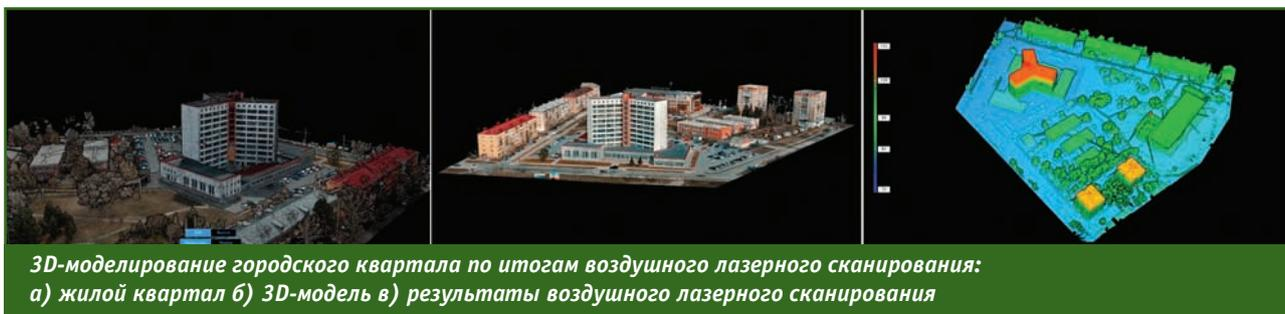
3D-моделирование городского квартала по итогам воздушного лазерного сканирования: а) жилой квартал б) 3D-модель в) результаты воздушного лазерного сканирования
