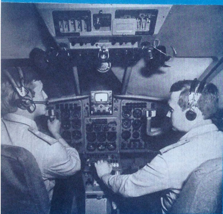
Комплексный тренажер самолета Як-40 позволяет будущим пилотам отрабатывать элементы техники пилотирования еще на земле.
