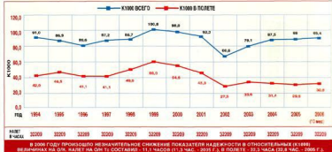
Распределение показателя надежности на 1000 часов налета по годам в ОАО «Аэрофлот» (подтвердившиеся отказы / неисправности)
