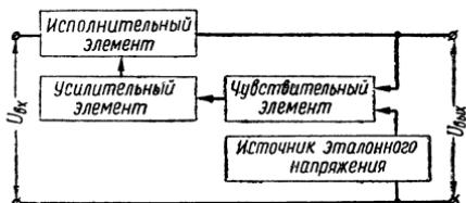
Рис. 15. Блок-схема стабилизатора напряжения компенсационного типа.
