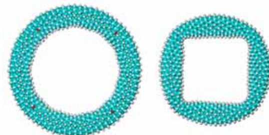
4 Гидрированное Z-нанокольцо C_{1728}H_{1728} из 12 деталей (рис. 2) в начале и через 20 часов оптимизации геометрии
