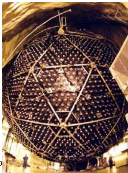
Нобелевские детекторы: очистка фотодетекторов на стенах Супер-Камиоканде (слева); установка SNO в шахте Садбери (справа)
