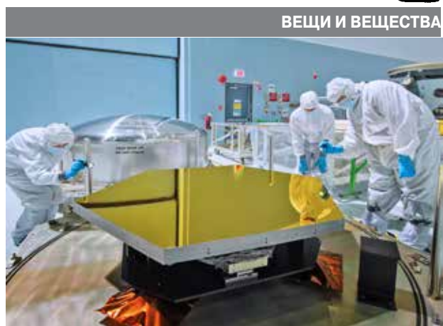
Инженер НАСА отправляет собранный фрагмент зеркала на криогенные испытания (слева). Проверка качества золотого покрытия на сегменте зеркала (вверху). Вес этой бериллиевой плиты — всего 20 кг
