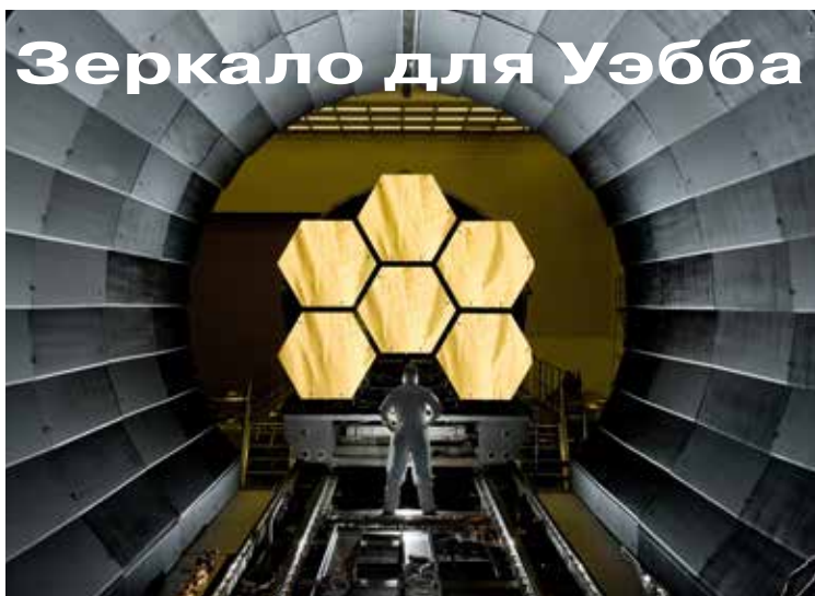
Инженер НАСА отправляет собранный фрагмент зеркала на криогенные испытания (слева). Проверка качества золотого покрытия на сегменте зеркала (вверху). Вес этой бериллиевой плиты — всего 20 кг
