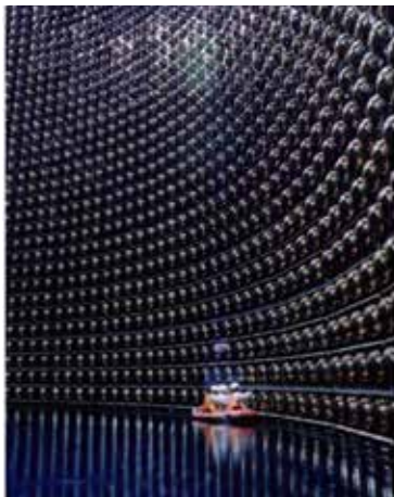
Нобелевские детекторы: очистка фотодетекторов на стенах Супер-Камиоканде (слева); установка SNO в шахте Садбери (справа)
