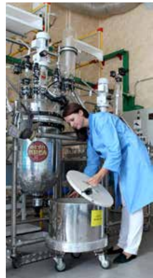
Загрузка реагентов в реактор. Подготовка нутч-фильтра для выделения готового продукта
