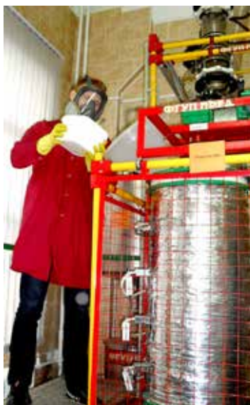
Загрузка реагентов в реактор. Подготовка нутч-фильтра для выделения готового продукта
