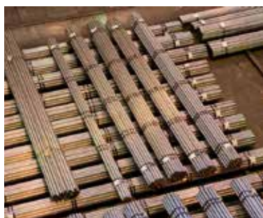
После обработки давлением получается готовое изделие, в данном случае прутки, который отправляют потребителям
