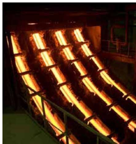
Выплавленную сталь разливают сначала в ковши, а потом в установку разливки, затем придают раскаленным брускам форму
