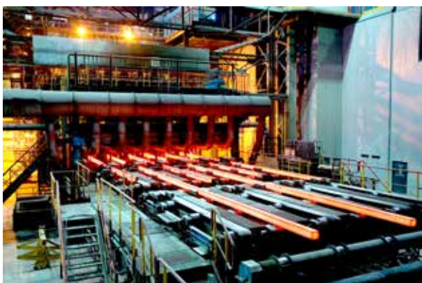
После обработки давлением получается готовое изделие, в данном случае прутки, который отправляют потребителям
