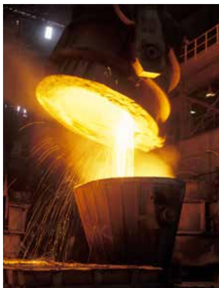
Выплавленную сталь разливают сначала в ковши, а потом в установку разливки, затем придают раскаленным брускам форму
