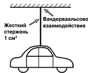
1 Вандерваальсовы силы: идеальный контакт площадью в один квадратный сантиметр выдерживал бы вес автомобиля
