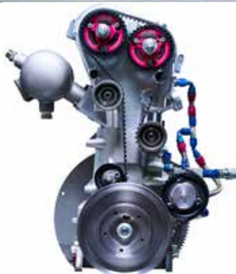
Накопитель энергии в виде башен с жидким азотом (вверху) или двигатель Дирмана (внизу) — элементы возможной азотной цивилизации. А рефрижиратор с двигателем Дирмана и с жидкоазотным холодильником уже обслуживает английские сетевые магазины (справа)
