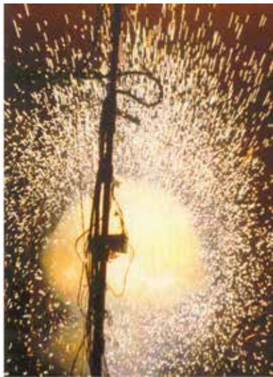
Долгоживущее плазменное образование, которое получили при сильноточном испарении медной фольги В.Н.Кунин и Л.В.Фуров (ВлГУ)
