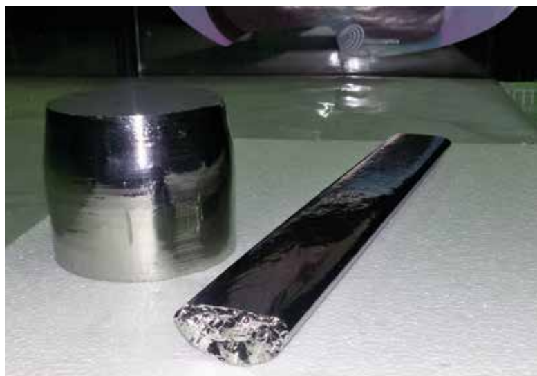
Слева — монокристалл германия, а справа — поликристалл
