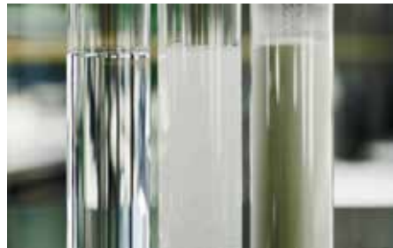
Уникальные свойства паучьего шелка способствуют его коммерческому применению. В пробирках гидрогели на основе паучьего шелка (слева и в центре), порошок из белков паучьего шелка (справа)
