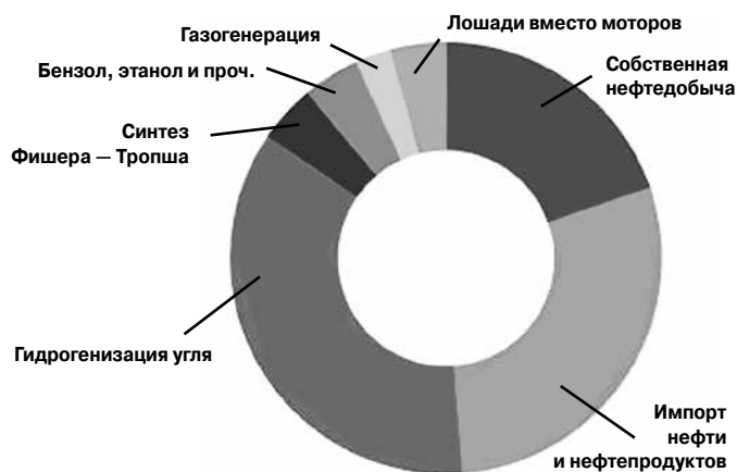
10 Вклад различных источников в обеспечение рейха моторным топливом
