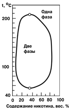
5 В системе «никотин — вода» область расслоения имеет и верхнюю, и нижнюю температуры расслаивания
