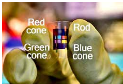
Фотография и виртуальное изображение фоторецепторов на гибкой подложке
