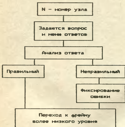
Схема обработки фрейма второго типа
