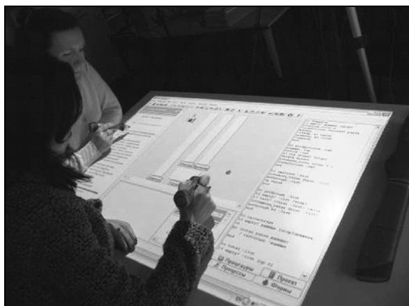
Рис. 2. Иллюстрация работы модели интерактивного стола с потолочным креплением проектора
