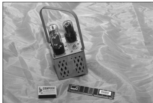
Ламповый триггер и оперативная память современного персонального компьютера
