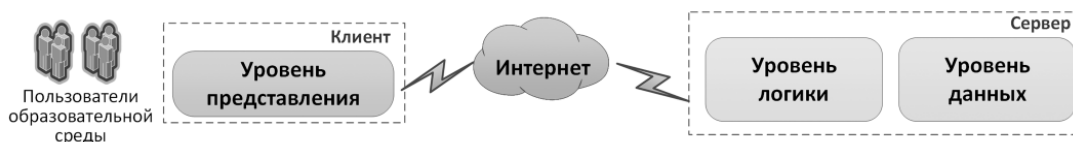
Рис. 1. Трехзвенная клиент-серверная архитектура
