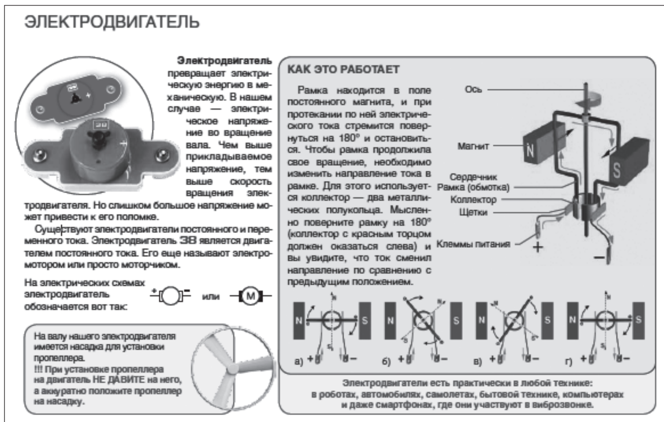
Рис. 2. Описание принципа работы электродвигателя для проекта с использованием набора «Электронный конструктор ЗНАТОК для Arduino BASIC. Версия EDUCATION»
