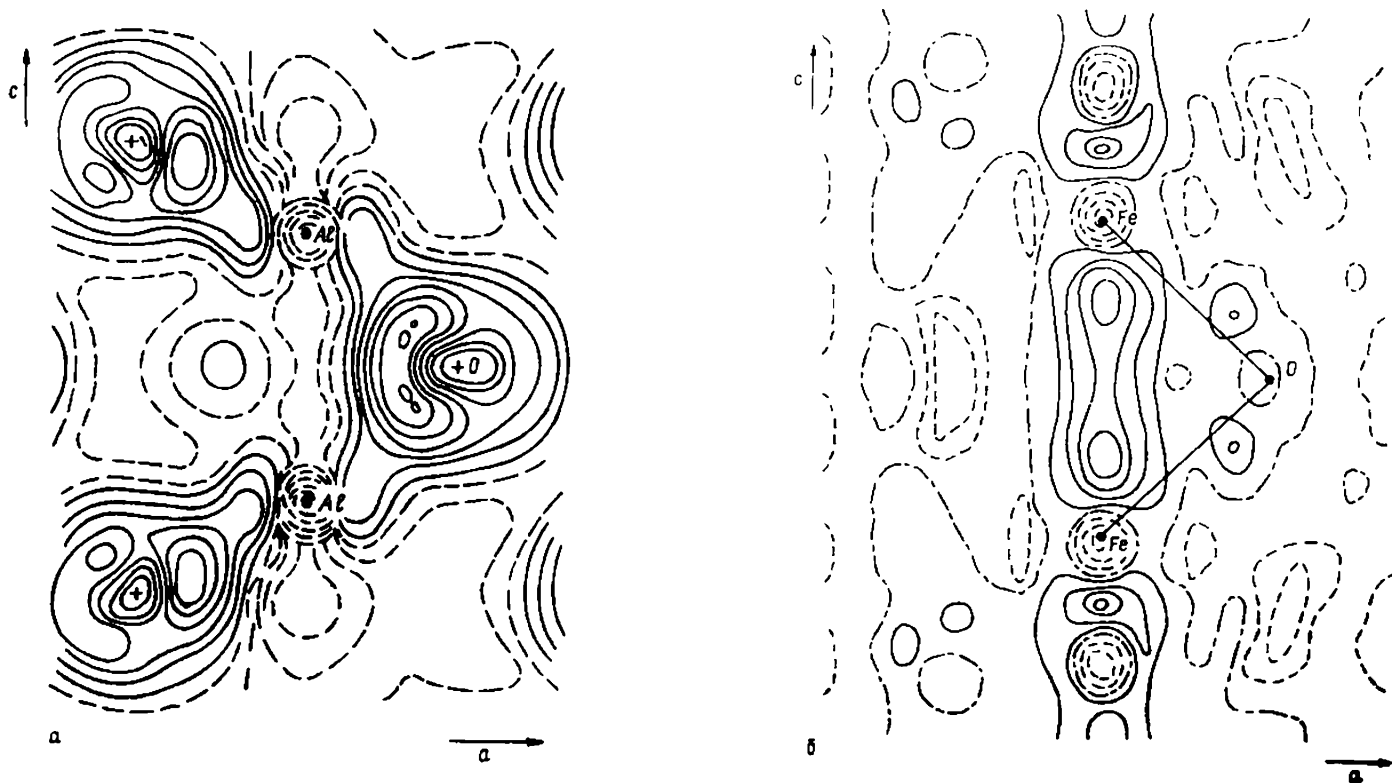
Рис. 11. Детали электронного строения кристаллов со структурой корунда: а — 2D-DERS-карта \alpha\text{-Al}_2\text{O}_3 (плоскость Al—O—Al), интервал между линиями 0,05 \text{ э. А}^{-3} [62], б — 2D-DEDD-карта \text{Fe}_2\text{O}_3 (плоскость Fe—O—Fe), изолинии проведены через значения \pm 0,1 , \pm 0,2 ; \pm 4 ; \pm 8 \text{ э. А}^{-3} [65]
