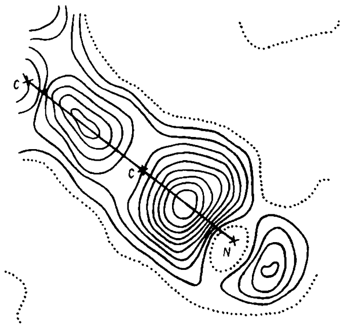
Рис. 13. Деформационная электронная плотность в кристаллах тетрацианоэтилена [72]; виден максимум \delta\rho , соответствующий неподеленной паре атома N
