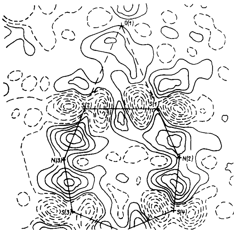
Рис. 30. 2D-DEDD-карта в плоскости тиотриазильного кольца в кристалле \text{S}_4\text{N}_3\text{NO}_3 [116]. Изолинии проведены через 0,05 \text{ э} \cdot \text{А}^{-3}
