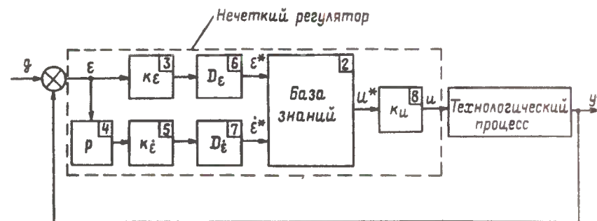
Рис. 1. Структурная схема интеллектуальной системы управления с нечетким регулятором
