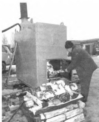
Газогенераторная печь конструкции Н.Егина.
