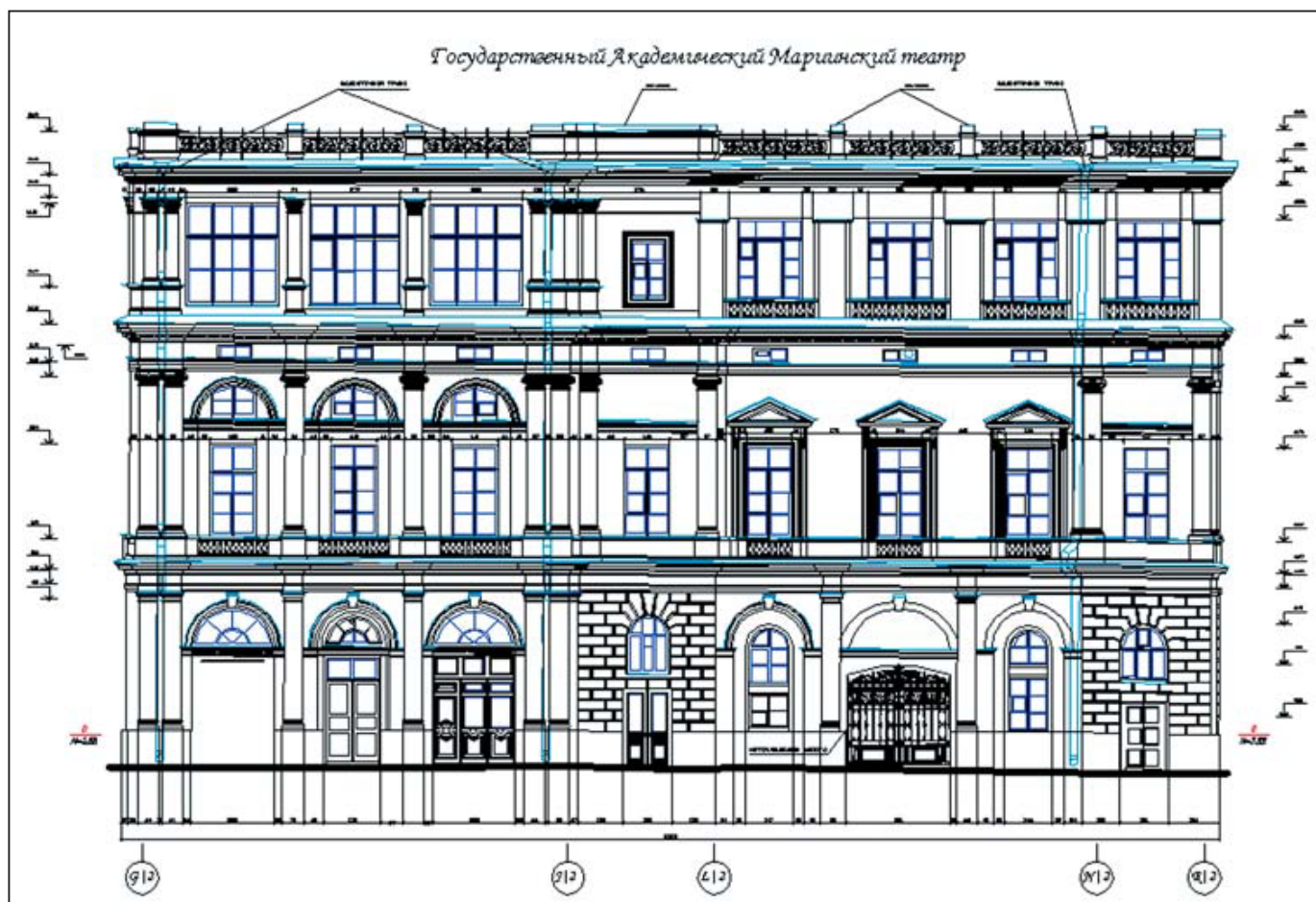
Рис.2. Обмерный чертеж Южного фасада здания Государственного Академического Мариинского театра, созданный стереофотограмметрическим методом.
