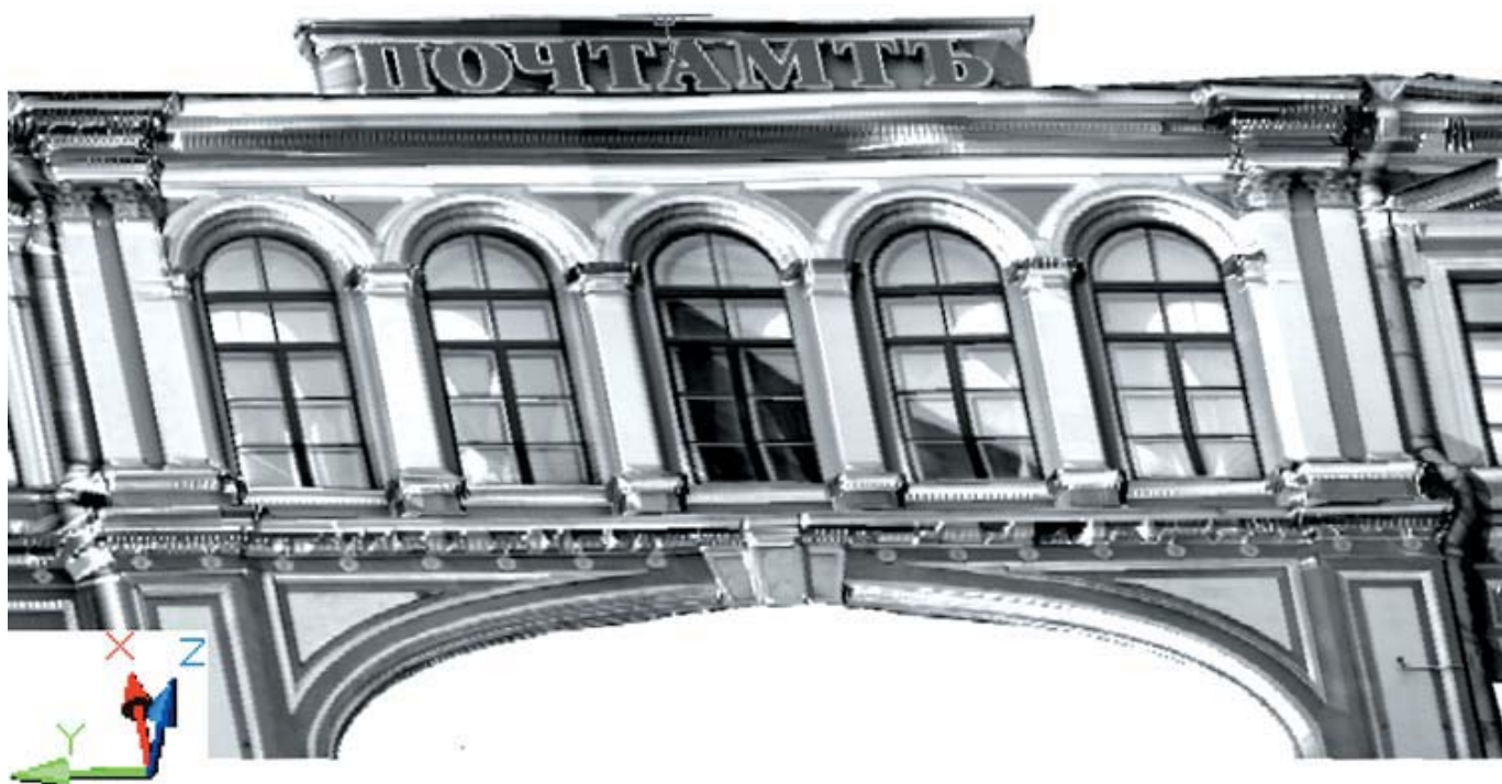
Рис.3. Пространственная модель фрагмента здания Главного почтамта.
