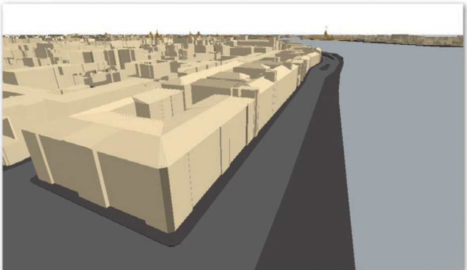
Рис. 3. Модели строений измеренные электронным тахеометром.
