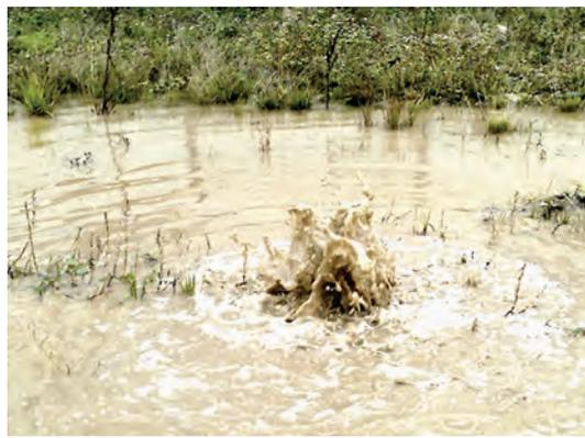
При выполнении статического зондирования и буровых работах на этом участке наблюдались интенсивные выделения биогаза (рис 1). На отдельных участках газ под давлением выбрасывал наружу столб грунтовых вод в виде водно-грязевого фонтана высотой до 3-4 м, а продолжительность газовыделения из скважины достигала 2-3 суток.
