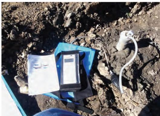
Рис. 3. Газогеохимическая съемка в глубоких скважинах.
