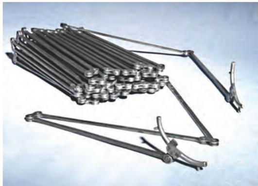
Рис. 5. 100-футовая цепь Рамсдена образца 1784 года.
