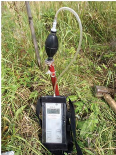
Рис. 4. Газогеохимическая съемка в шпурах (глубины до 1,5 м).
