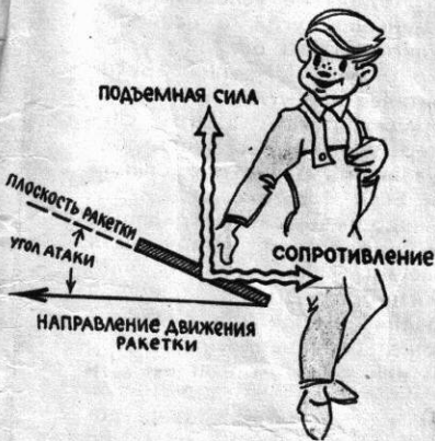
Когда угол атаки не равен нулю, то, помимо сопротивления, возникает подъемная сила.
