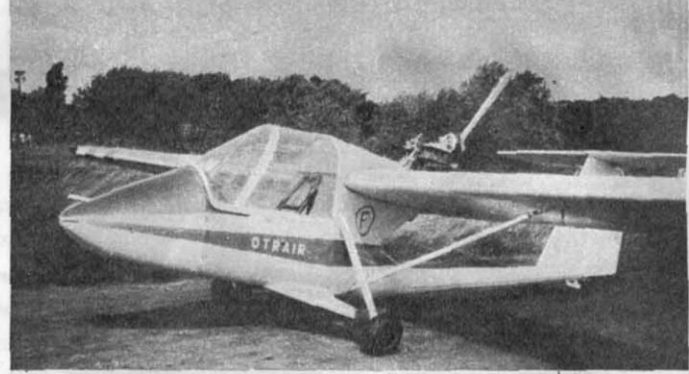
«OTRAIR-F» — ленинградский самолет выполнен в основном из пластика.
