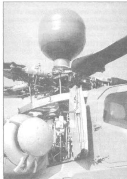
Ми-28Н. Радар, на воздухозаборнике двигателя — пылезащитное устройство.
