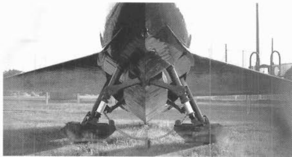
Носовые стойки лыж. Видны штоки амортизаторов. Лыжи в буксировочном положении.
