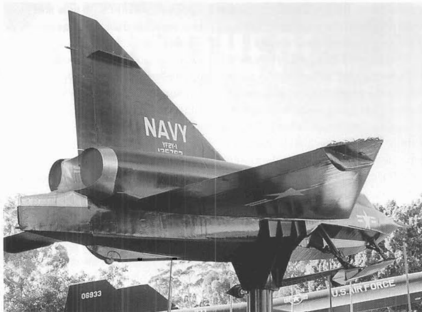
Си Дарт № 3, установленный перед входом в Аэрокосмический музей в Сан Диего. Видно хвостовое колесо в обтекателе. Колеса на лыжах в рабочем положении. Видна конструкция кормового руля - тормоза и соплового блока. Трубка ПВД на вершине киля отсутствует. Под крылом виден обтекатель бустера элевона. Правая законцовка крыла повреждена. Фото Майкл Бэлдок. Airliners.net.
