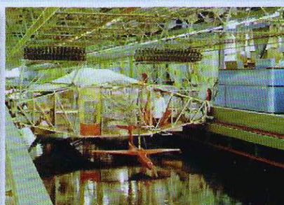
Исследование обтекания модели вертолета гидродинамической трубе ЦАГИ
