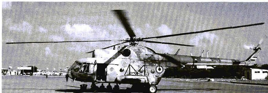
Сирийские "восьмерки" широко используются для выброски парашютистов, для чего на них снимаются створки кормового люка (причем такой вариант никогда не использовался в ВВС СССР).
