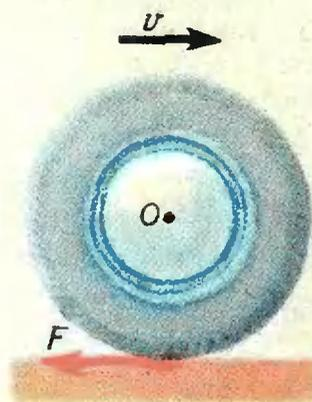
3. Когда шфер нажимает тормозную педаль, колодки тормозов прижимаются к колесам и замедляют их вращение. Но силы взаимодействия колес и тормозных колодок являются внутренними и, следовательно, не могут уменьшить скорость автомобиля. Почему же автомобиль останавливается?
