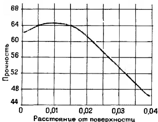
Рис. 4. Поверхностно закаленная сталь возникает в результате специфической диффузии в нее атомов углерода. В средней части рисунка приведена микрофотография, иллюстрирующая распределение углерода в куске стали, поверхность которого находилась в контакте с углеводородом. Верхняя кривая дает процентное содержание углерода в зависимости от расстояния до поверхности куска стали. Нижняя кривая характеризует прочность стали в различных частях куска.
