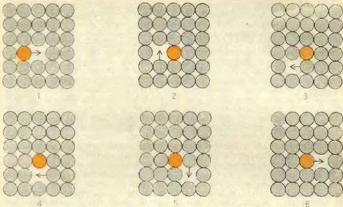
Рис. 2. В атомных плоскостях кристалла возможно наличие вакантных мест. Этот рисунок иллюстрирует, каким образом золото (желтый кружок) может диффундировать в кристалле свинца. Переход атома золота в положение, изображенное на правом нижнем рисунке, возможен при наличии всего лишь одной вакансии в решетке свинца.
