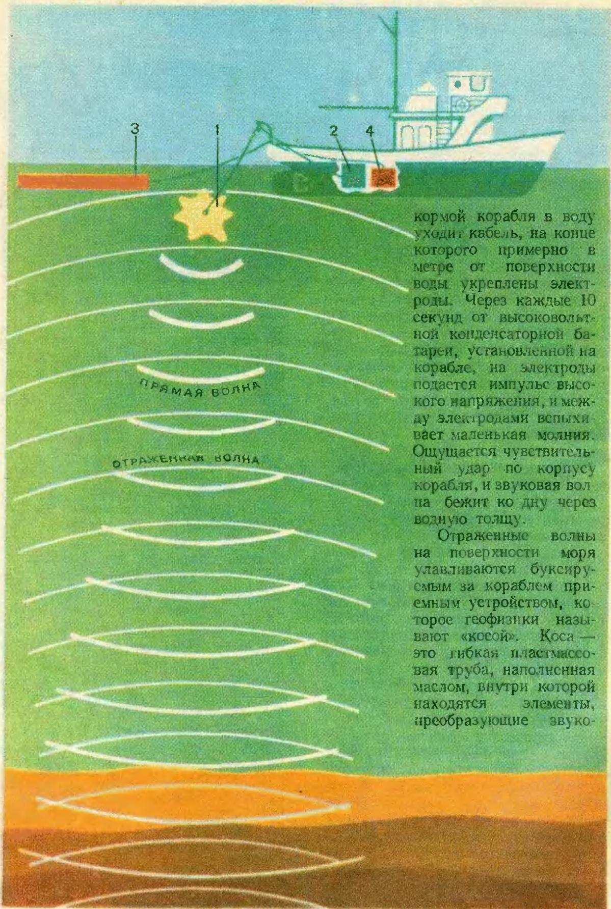
кормой корабля в воду уходит кабель, на конце которого примерно в метре от поверхности воды укреплены электроды. Через каждые 10 секунд от высоковольтной конденсаторной батареи, установленной на корабле, на электроды подается импульс высокого напряжения, и между электродами вспыхивает маленькая молния. Ощущается чувствительный удар по корпусу корабля, и звуковая волна бежит ко дну через водную толщу.
