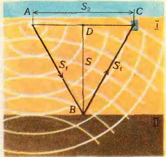
Рис. 1. Принципиальная схема сейсморазведки.
