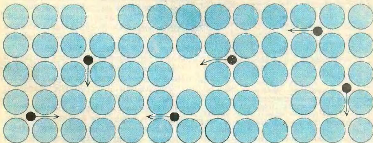
Рис. 3. Диффузия углерода в железе не зависит от наличия вакансий. Атомы углерода (черные кружки) достаточно малы, чтобы располагаться между атомами железа (голубые кружки).
