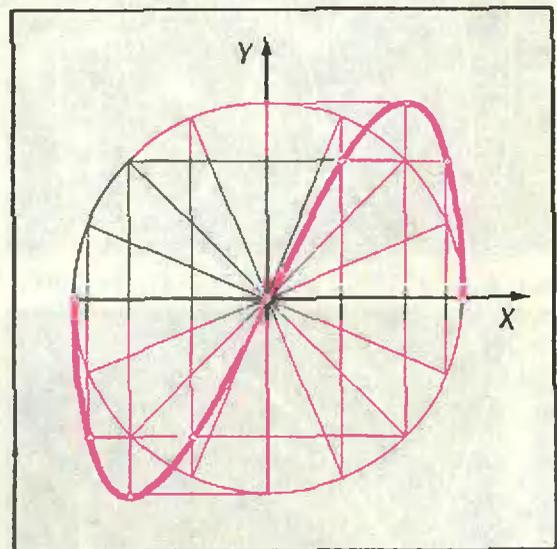
Рис. 6. Построение кривой, соответствующей системе  $x = A \cos \omega t$ ,  $y = A \sin 2\omega t$ .
