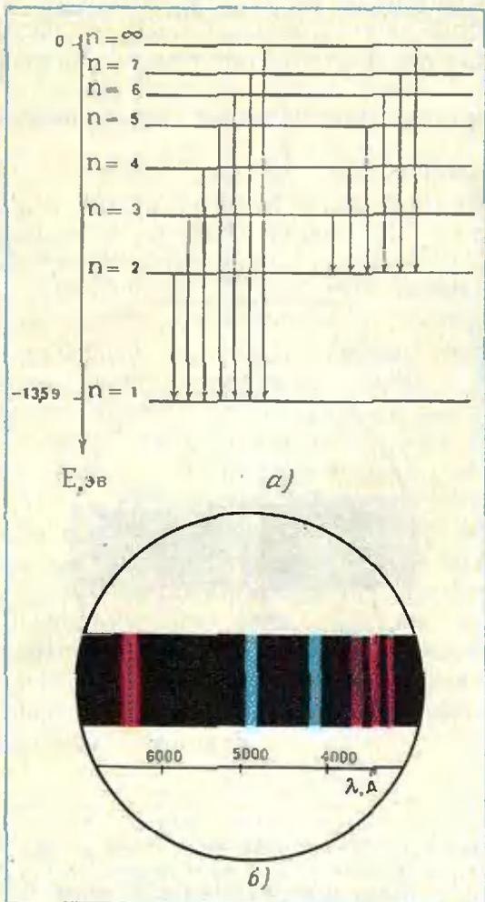
Рис. 2. а) Схема уровней атома водорода. Показаны переходы на уровни с  $n=1$  и  $n=2$ . б) Спектр излучения атомарного водорода в видимой области — переходы на уровень с  $n=2$ . Такая картина наблюдается в спектрометре.
