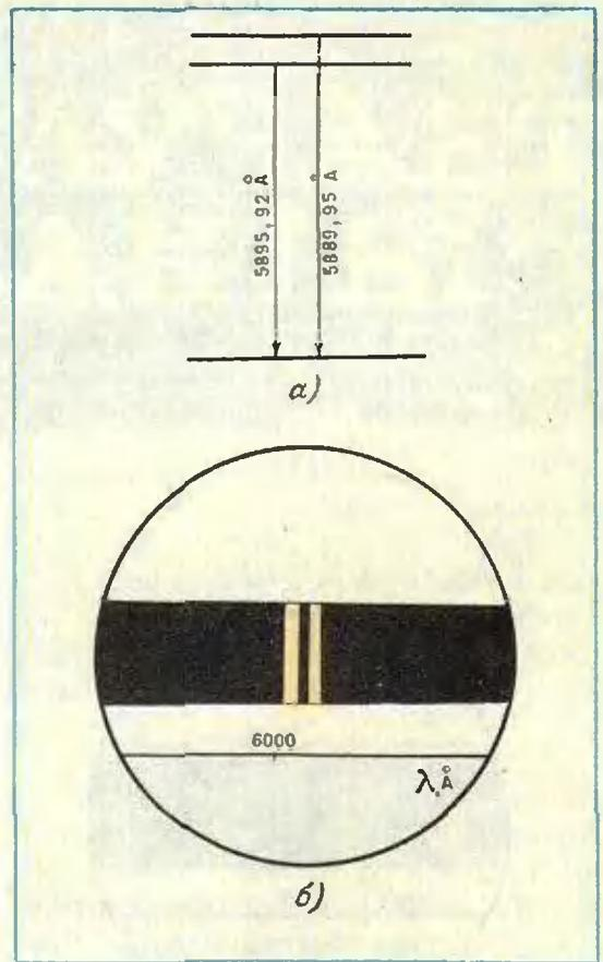
Рис. 3. а) Спектр излучения атома натрия в видимой области. б) В поле зрения спектрометра наблюдаются две желтые линии.
