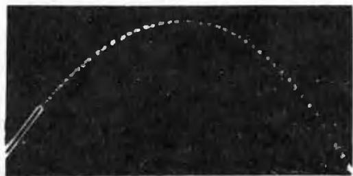
Рис. 4. Вид слипшейся струн через стробоскоп.
