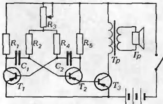
Рис. 1. Принципиальная схема генератора. Параметры схемы: транзисторы  $T_1$ — $T_3$  типа МП41; динамик  $I_p$  типа 0,5ГД21; трансформатор  $Tr$  — выходной от карманного радиоприемника; напряжение питания 4,5—9 в (одна или две последовательно соединенные батарейки для карманного фонаря);  $R_1 = R_5 = 10$  ком,  $R_2 = R_4 = 47$  ком,  $R_3 = 68$  ком,  $C_1 = C_2 = 0,05$  мкф.
