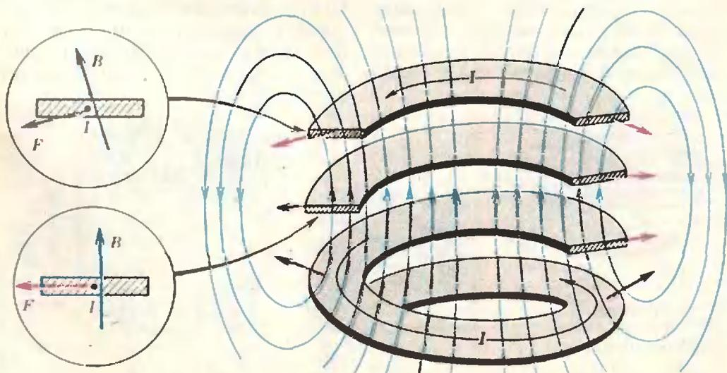
Рис. 2. Силы, действующие со стороны магнитного поля на соленоид.
