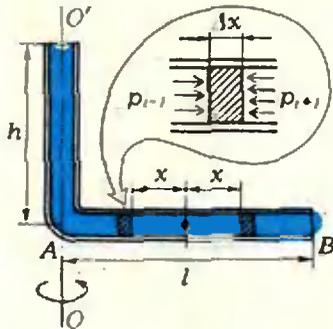
Пусть  $\omega$  — предельная угловая скорость вращения капилляра. Разобьем мысленно горизонтальное колено на  $N$  отрезков малой длины  $\Delta x = l/N$  ( $\Delta x \ll l$ ). Рассмотрим два малых элемента массы воды  $\Delta m = \pi r^2 \rho \cdot \Delta x$ , находящихся на расстояниях  $x$  от середины колена (см. рисунок). Запишем уравнения движения этих элементов:
