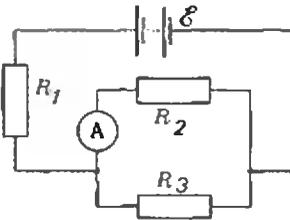
7. Батарея аккумуляторов с ЭДС  $\mathcal{E} = 2,8 \text{ В}$  включена в цепь, как показано на рисунке. Здесь  $R_1 = 1,8 \text{ Ом}$ ,  $R_2 = 2 \text{ Ом}$ ,  $R_3 = 3 \text{ Ом}$  и амперметр показывает  $I = 0,48 \text{ А}$ . Определите внутреннее сопротивление батареи. Сопротивлением амперметра можно пренебречь.
