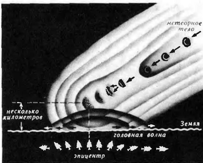
Схема влета в атмосферу и взрыва Тунгусского тела. Образовавшаяся у поверхности Земли головная волна и явилась причиной повала деревьев.
