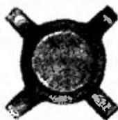
Современный сверхвысокочастотный транзистор (увеличение 5). Коэффициент усиления  $\beta \approx 30$ , время переключения  $\approx 200$  пс, диаметр корпуса 3 мм, толщина 1,5 мм.
