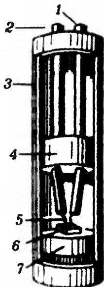
Первый промышленный биполярный транзистор (1948 г.). Эмиттерный и коллекторный переходы изготавливаются сплавлением в германиевый кристалл тонких проволочек. Коэффициент усиления  $\beta \approx 2$ , время переключения  $t_0 \approx 30$  мкс, диаметр корпуса 1 см, высота 4 см.
