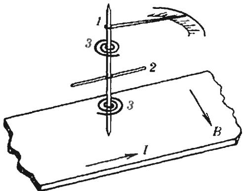
лку в противоположном направлении и растет с увеличением угла поворота. Такой противодействующий момент может быть создан, например, подходящей пружиной.
