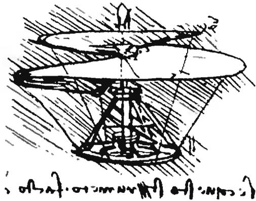
«...когда этот прибор, сделанный винтом... быстро приводится во вращение —...винт ввинчивается в воздух и поднимается вверх» — таким текстом сопроводил Леонардо да Винчи этот свой эскиз летательного аппарата.
