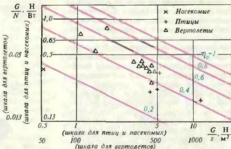
Рис. 3. Зависимость удельной взлетной мощности от нагрузки на ометаемую площадь.
